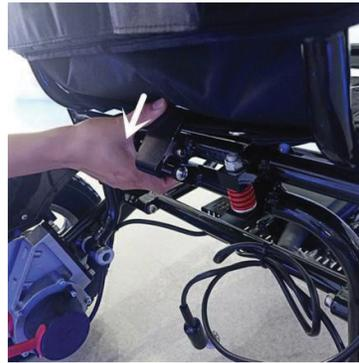
1. Glissez le contrôleur dans la fente ouverte du bras de la Mobi sur le côté droit (à moins qu'il ne soit précommandé pour les utilisateurs gauchers). Serrez le bouton situé sous l'accoudoir pour fixer le contrôleur en place.
