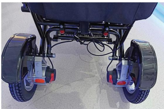
**Remarque:** Pour votre sécurité prenez note que dans la mode roue libre le mécanisme d'entraînement des roues est désengagé donc les freins sont aussi désengagés. N'embarquer jamais dans la Mobi quand elle est en mode roue libre. La personne qui pousse un passager dans cette mode doit prendre responsabilité pour conduire son passager prudemment.
