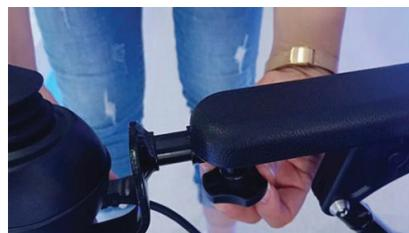
2. Branchez le connecteur du câble du contrôleur au connecteur du câble qui s'écoule de l'accouoir de la chaise elle-même, en prenant soin d'aligner les broches correctement afin qu'elles ne soient pas pliées, cassées ou endommagées.
